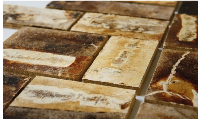
Am Karlsruher Institut für Technologie (KIT) hergestellte Pilzstoffplatten.
